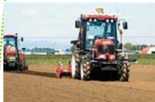
衛星測位情報を用いた自動運転により作業時間を4割削減
